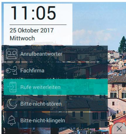
Durch erneutes Antippen der Taste „Rufweitzerschaltung“ wird die Funktion deaktiviert. Dadurch kehrt die Taste zur normalen Anzeige zurück und das Symbol in der oberen Leiste wird ausgeblendet.
