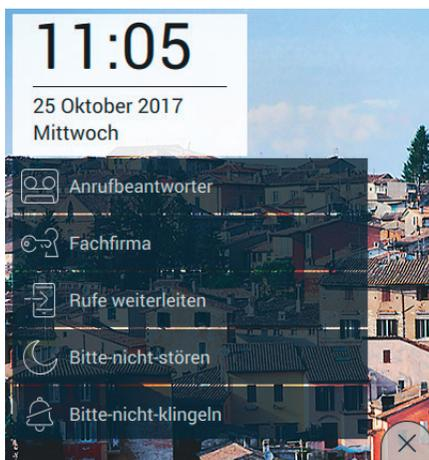
Die Hotkeys stehen für 30 Sekunden zur Verfügung, danach kehrt die Anwendung zur normalen Anzeige zurück.
