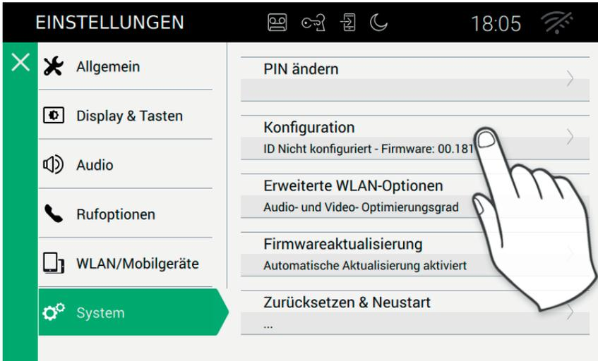
Bevor es betriebsbereit ist, muss das Gerät mit einer eindeutigen ID-Adresse innerhalb der 2-Draht-Busanlage konfiguriert werden.
