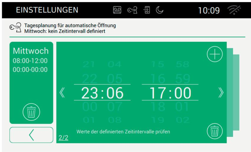
Die Übersicht mit allen Intervallen wird erst aktualisiert, nachdem der Benutzer eine der verfügbaren Tasten betätigt hat.
