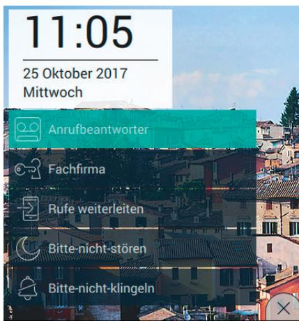
Durch erneutes Antippen der Taste „Anrufbeantworter“ wird die Funktion deaktiviert. Dadurch kehrt die Taste zur normalen Anzeige zurück und das Symbol in der oberen Leiste wird ausgeblendet. Die am Klingeltableau oder Intercom eingestellte Antwortzeit ist die Zeit, die der Benutzer hat, um den Anruf zu beantworten. Bei den Intercom-Anrufen ist der Wert konstant 30 Sekunden, während am Klingeltableau ein Wert zwischen 1 und 255 Sekunden eingestellt werden kann.
