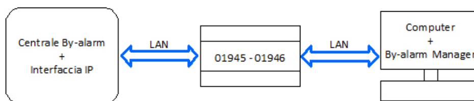
Figura 1 - Connessione locale tra By-alarm Manager e centrale By-alarm
