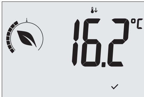
Abb. 13: Übergang in den Reduzierten Nachtbetrieb mit Anzeige des reduzierten Sollwerts
