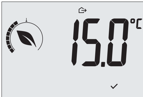
Abb. 11: Übergang in die Betriebsart Abwesenheit mit Anzeige der Abwesenheitstemperatur
