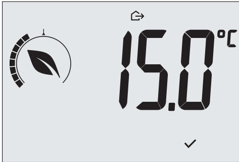
Εικ. 11: Είσοδος στον τρόπο λειτουργίας απουσίας με επισήμανση της θερμοκρασίας απουσίας
