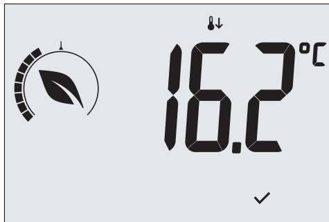
Εικ. 13: Είσοδος στον τρόπο λειτουργίας «Μείωση τη νύχτα» με επισήμανση της τιμής ρύθμισης μείωσης
