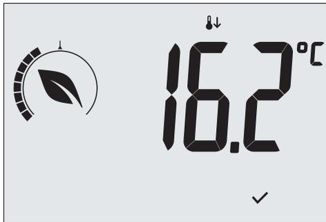
Fig. 13: Ingresso in modalità Riduzione Notturna con evidenza del set point di riduzione
