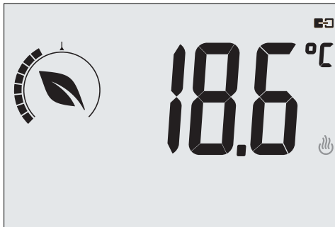
Abb. 14: Übergang in die ferngeschaltete Betriebsart Hand
