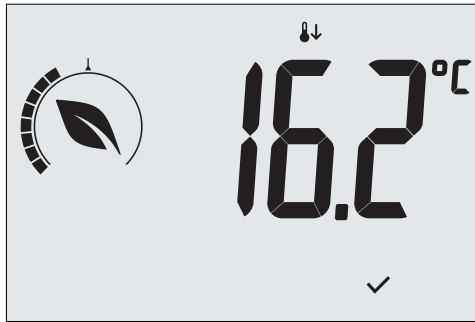
Εικ. 10: Είσοδος στον τρόπο λειτουργίας «Μείωση τη νύχτα» με επισήμανση της τιμής ρύθμισης μείωσης
