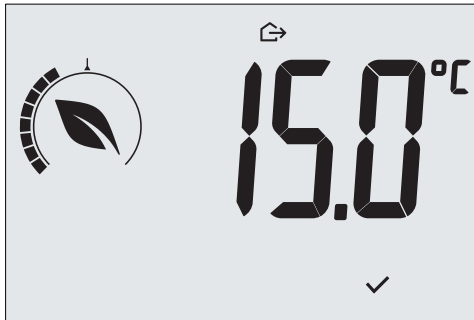
Εικ. 8: Είσοδος στον τρόπο λειτουργίας απουσίας με επισημάνση της θερμοκρασίας απουσίας
