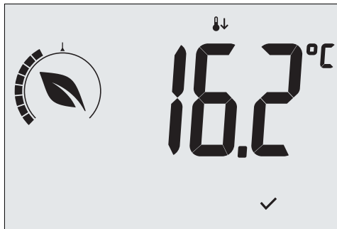
Fig. 10: Ingresso in modalità Riduzione Notturna con evidenza del set point di riduzione
