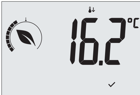
Abb. 14: Übergang in den Reduzierten Nachtbetrieb mit Anzeige des reduzierten Sollwerts
