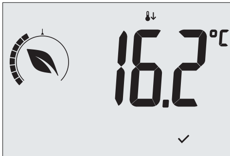
Fig. 14 : Entrée en mode Nuit avec affichage du point de consigne de la réduction.
