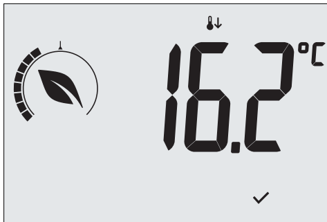
Fig. 9: Ingresso in modalità Riduzione Notturna con evidenza del set point di riduzione
