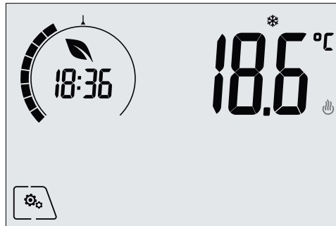
Εικ. 25: Τρόπος λειτουργίας προστασίας από τον παγετό
