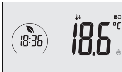
Abb. 22: Übergang in den ferngeschalteten reduzierten Betrieb
