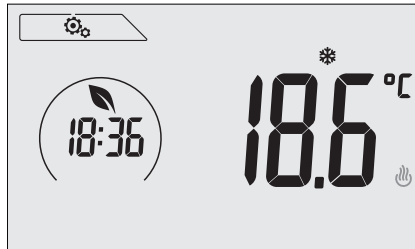
Εικ. 21: Τρόπος λειτουργίας προστασίας από τον παγετό
