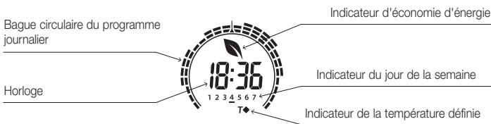
Fig. 9 : Affichage typique de l'horloge et du programme journalier
