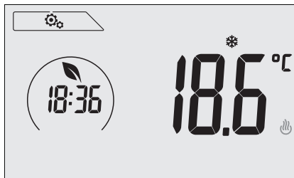
Εικ. 15: Τρόπος λειτουργίας προστασίας από τον παγετό
