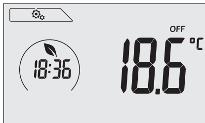
Fig. 7 : Affichage typique du mode OFF
