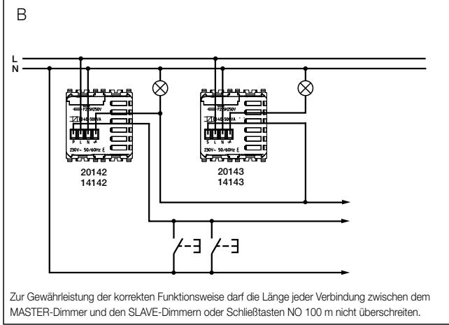
Zur Gewährleistung der korrekten Funktionsweise darf die Länge jeder Verbindung zwischen dem MASTER-Dimmer und den SLAVE-Dimmern oder Schließtasten NO 100 m nicht überschreiten.
