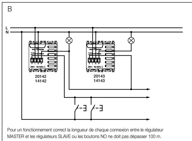
Pour un fonctionnement correct la longueur de chaque connexion entre le régulateur MASTER et les régulateurs SLAVE ou les boutons NO ne doit pas dépasser 100 m.
