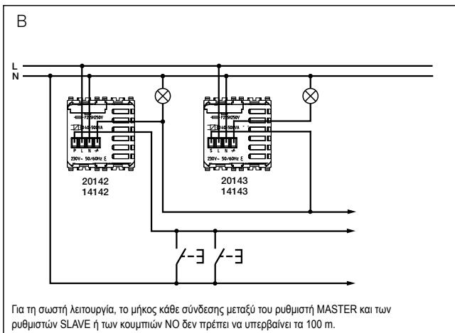
Για τη σωστή λειτουργία, το μήκος κάθε σύνδεσης μεταξύ του ρυθμιστή MASTER και των ρυθμιστών SLAVE ή των κουμπιών NO δεν πρέπει να υπερβαίνει τα 100 m.
