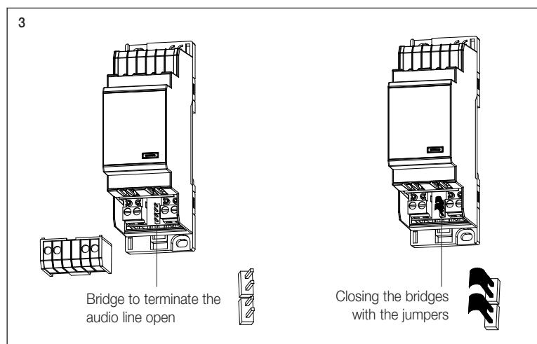
Syntoniseur radio FM avec RDS, connecteur coaxial pour antenne FM externe, terminaison de ligne intégrée, installation sur rail DIN (60715 TH35), occupe 2 modules de 17,5 mm.
