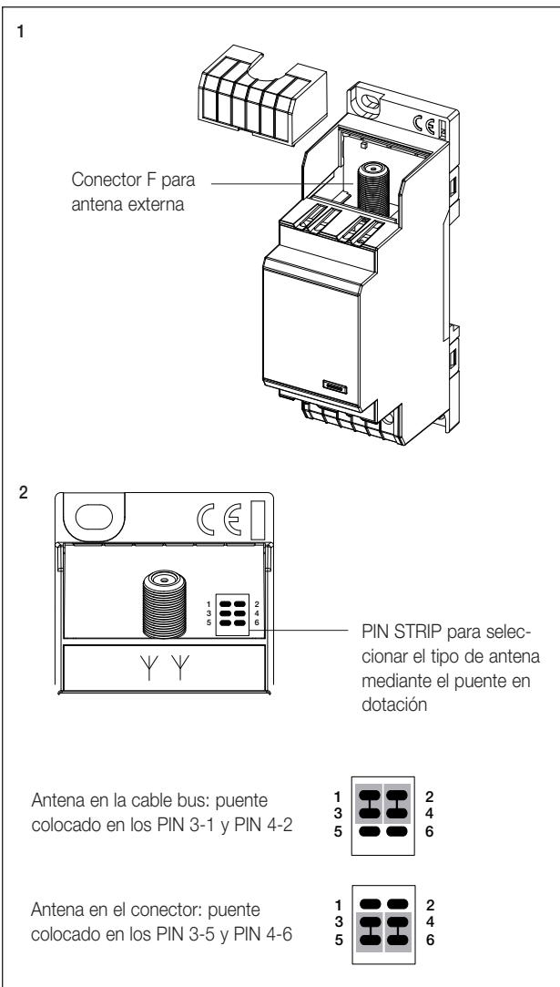
UKW-Tuner mit RDS, Koaxialstecker für externe UKW-Antenne, eingebauter Leitungsabschluss, Hutschienenmontage nach DIN (60715 TH35), belegt 2 Modulplätze à 17,5 mm.
