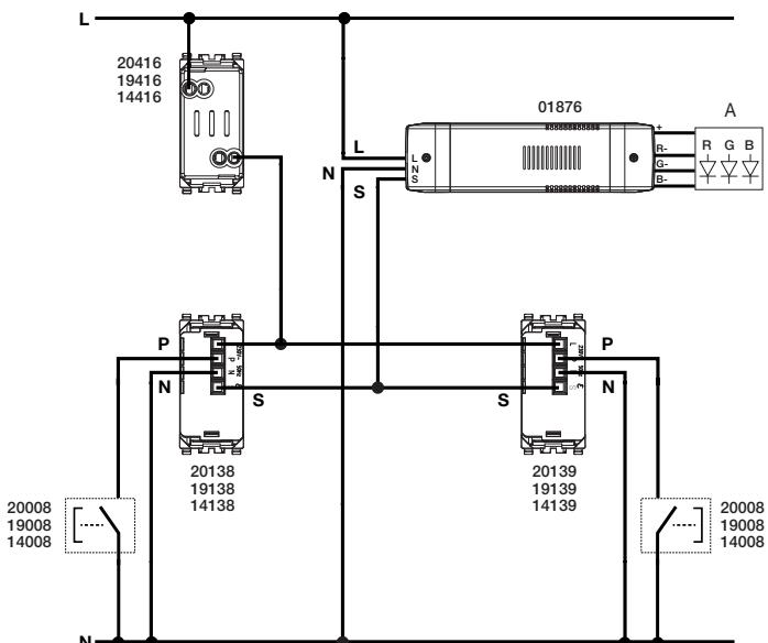
A: Modulo LED RGB - Strisce LED RGB • Module RGB LED - Strip RGB LED
