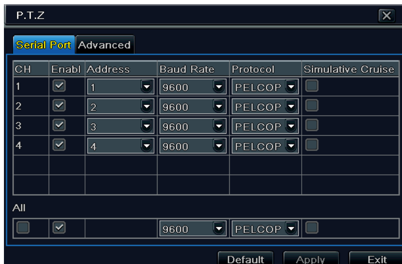
Fig. 4-32 Configurazione PTZ - Porta seriale
