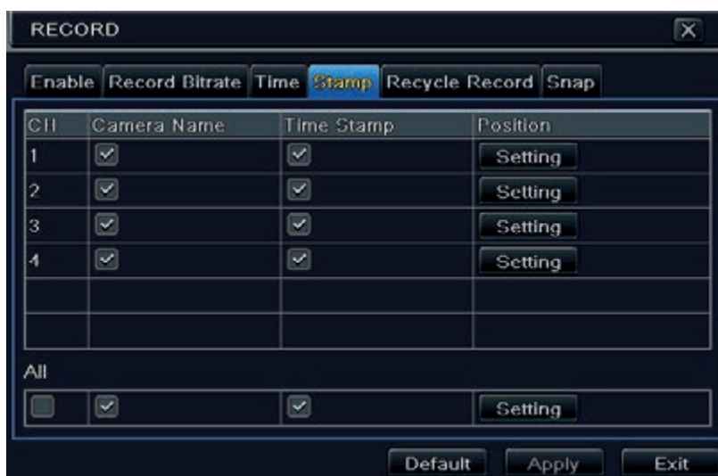
Fig. 4-13 Configurazione della registrazione - Timbro
