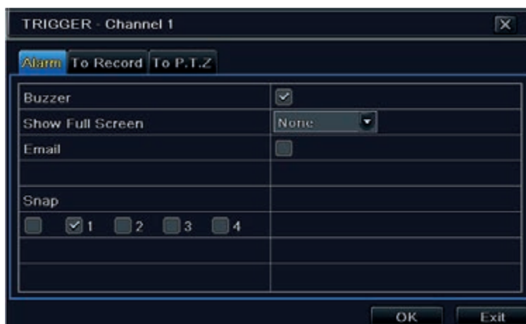
Fig. 4.-17 Configurazione allarme - Attivazione per movimento
