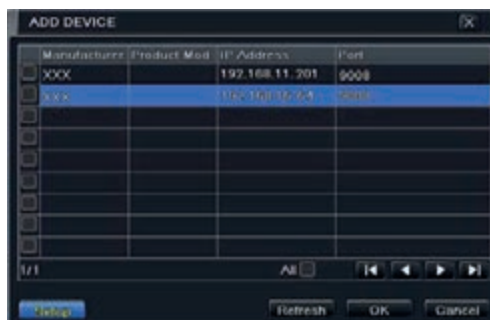
Fig. 4-2 Aggiunta di dispositivi
