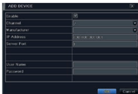
Fig. 4-6 Aggiunta di dispositivi
