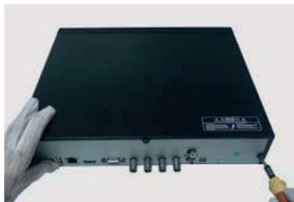
1. Allentare le viti sui lati inferiore e laterale del dispositivo per togliere il coperchio
