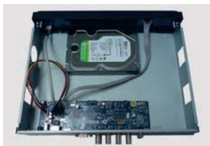
3. Inserire l'HDD sul fondo del dispositivo.
