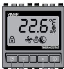
Permette di introdurre una temporizzazione per la modalità di funzionamento selezionata.
