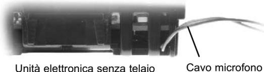
Unità elettronica senza telaio
