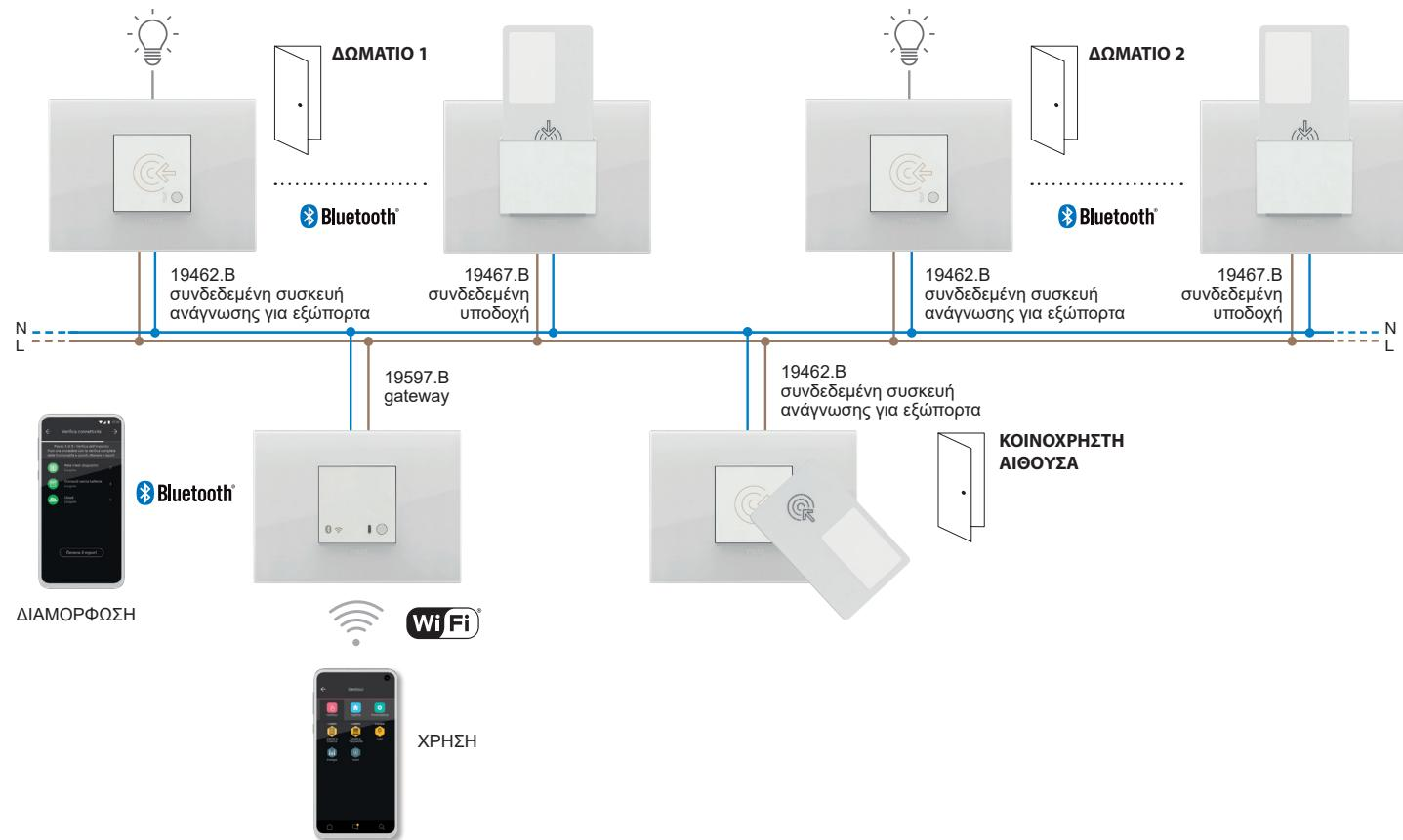
Παράδειγμα αρχιτεκτονικής συστήματος View Wireless με μηχανισμούς χωνευτής εγκατάστασης και πρότυπο Zigbee technology:
