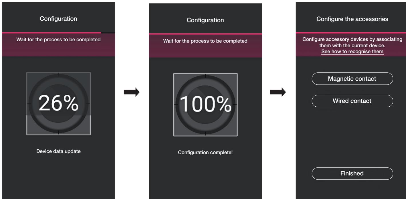
En sélectionnant « Contact magnétique », le thermostat pourra être associé à un contact magnétique afin de détecter l'ouverture d'une porte/fenêtre.
