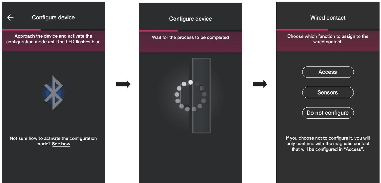
En sélectionnant « Accès », le contact filaire pourra être utilisé pour détecter l'ouverture d'une porte ou d'une fenêtre.
