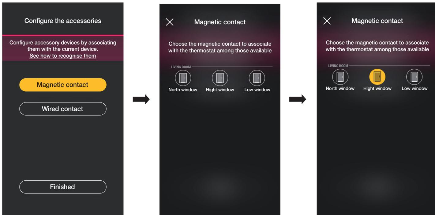
L'appli complètera l'association et le thermostat sera associé au contact « Fenêtre haute » (si la fenêtre est ouverte, la notification sera transmise et la régulation thermique sera interrompue).
