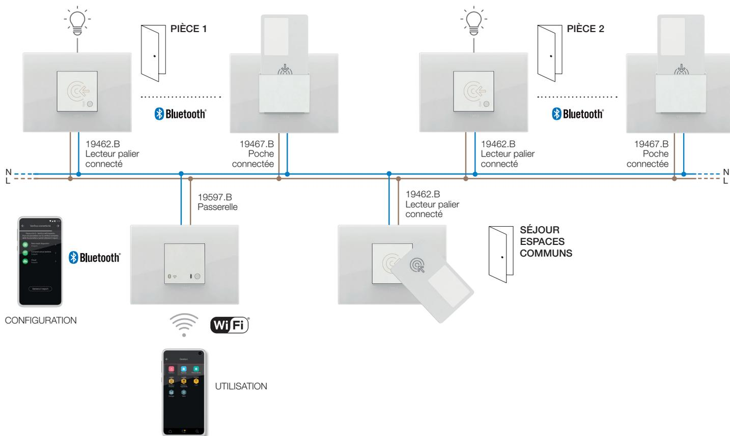
Exemple d'architecture du système View Wireless avec dispositifs d'encastrement et standard Zigbee technology :
