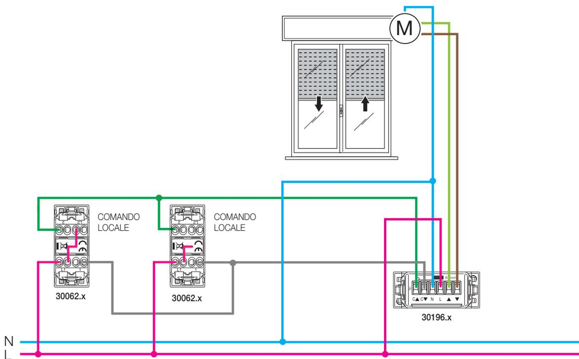
COLLEGAMENTO CENTRALIZZAZIONE TAPPARELLE CON 30196.x-20196-19196-14196 e 03996
